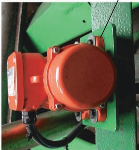
Vibreur boulonné sur plaque horizontale
