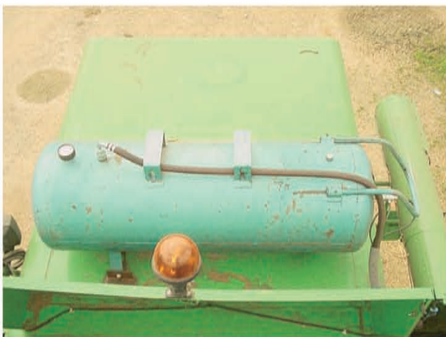
cuve d'air ajoutée
