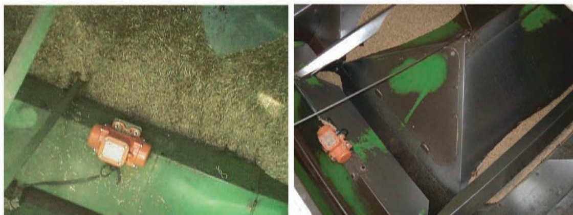
Montage sur capot de vis de vidange
