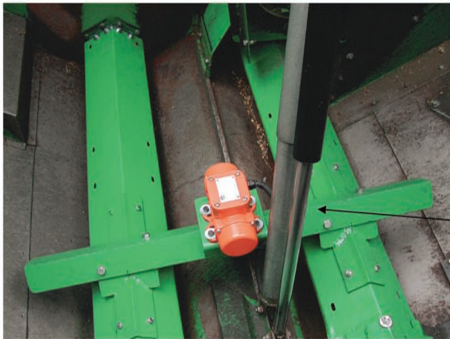
Ajout d'une plaque conique boulonnée sur les supports sur capots
