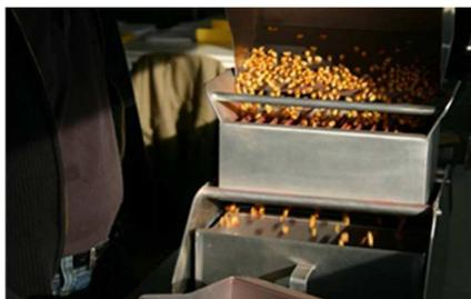
Dans le cas des diviseurs à rifles, l'échantillonneur peut influencer la qualité de l'échantillonnage en manipulant les récipients ; le diviseur doit donc être contrôlé avec chaque personne amenée à l'utiliser. Ce test peut alors aussi servir d'outil de vérification du maintien de la compétence de l'échantillonneur.
