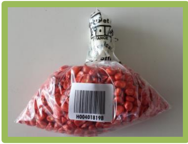
1 - échantillon bien fermé avec repli du sachet avant fermeture et pas d'air
