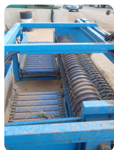
L'andaineuse, montée à l'arrière du tracteur, peut être utilisée seule pour retourner les andains
